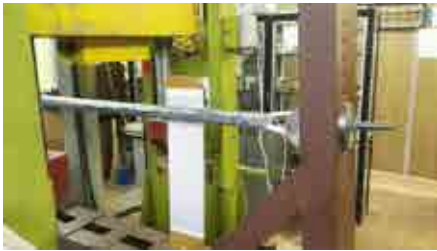
Рисунок 13. Фрагменты исследований инновационного тросового элемента — ленты из ВСМПЭ — для дорожного ограждения: слева — испытания ленты из ВСМПЭ на разрыв, внизу — испытания на удар, справа — вид КЭ-модели с узлом крепления ленты в модели виртуальных испытаний
