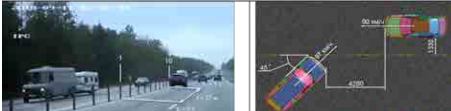
Рисунок 11. Съемка с видеорегистратора и воспроизведенная первоначальная схема наезда
