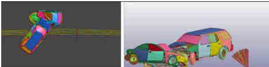
Рисунок 12. Фрагмент виртуального наезда автомобиля на тросовое ограждение и далее на автомобиль, двигавшийся по встречной полосе
