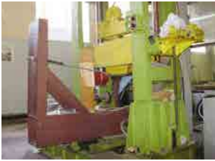
Рисунок 3. Стендовые ударные испытания тросов для ТДО и цифровой двойник
